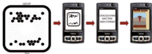
Dekódování beetaggů mobilním telefonem s fotoaparát a vybaveným čtečkou Dekodierung von Bee Taggs mit einem Mobiltelefon mit Kamera und Lesegerät Reading beetagg with mobile phone equipped with camera and tag-reader app
